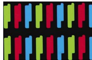
Filtere de couleur d'un écran LCD (lumière transmise/BF)
