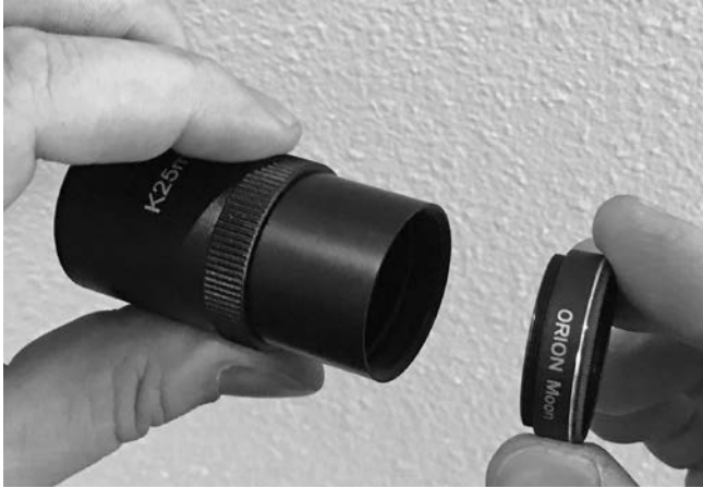
Abbildung 21. Die Steckhülsen der Kellner-Okulare sind mit Gewinde versehen, in die separat erhältliche 1,25" (32 mm) Orion-Filter passen. Ein Mondfilter ist nützlich, um Blendung zu reduzieren und so mehr Details auf der Mondoberfläche zu zeigen.
