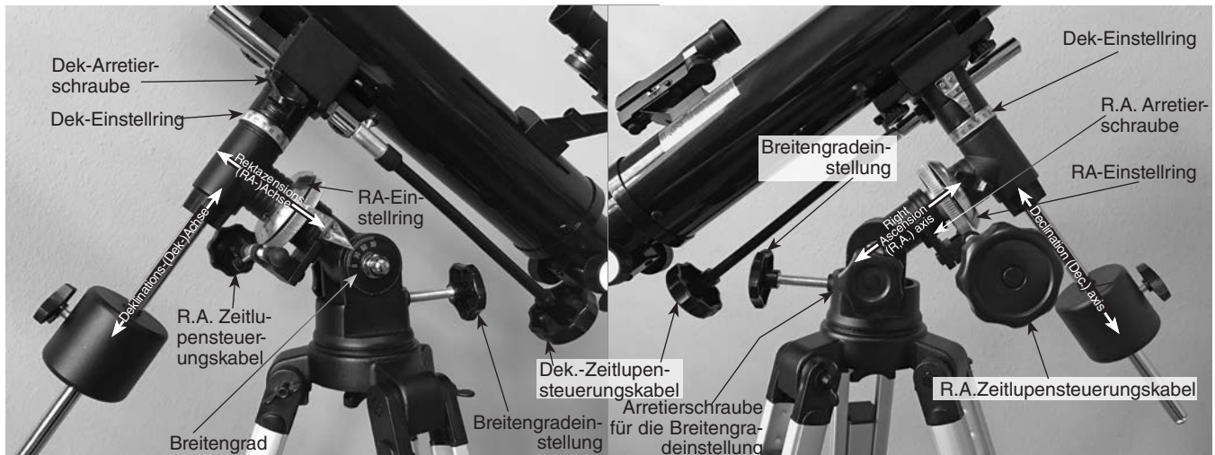
Abbildung 18. Komponenten der parallaktischen Montierung – Ansicht von beiden Seiten.
