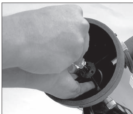
Figure 13. Pour centrer le miroir secondaire sous le système de mise au point, maintenez le support du miroir en place d'une main tout en ajustant le boulon central à l'aide d'un tournevis cruciforme. Ne touchez pas la surface du miroir !
