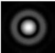
sogenannte Airyscheibchen, mit einem oder mehreren konzentrischen, runden Beugungsringen. Bitte beachten Sie, dass dieses Bild in der Regel auch bei perfekt justierter Optik so nicht zu sehen ist – das Sternscheibchen tanzt und wabert durch die Luftunruhe. Man muss also eine Weile am Okular bleiben um beurteilen zu
