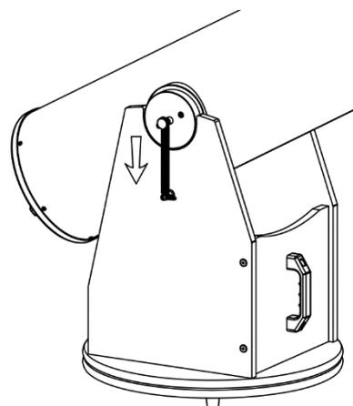
**Utilisation du ressort.** Faites passer un crochet (G) sur le cylindre en nylon (I) et fixez-le en serrant la molette (F). Le ressort est alors détendu. Reliez l'autre boucle du ressort au cordon E. Étirez le ressort en tirant sur la boucle et en l'accrochant à l'autre cylindre en nylon. Recommencez l'opération sur les deux coussinets latéraux.
