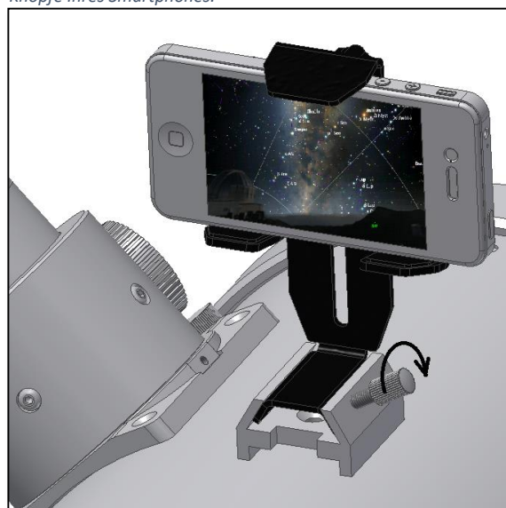
Abb. 5. Schieben Sie den Fuß des Smartphoneadapters in den Sucherschuh Ihres Teleskops. Fixieren Sie den Adapter mit der seitlichen Schraube.
