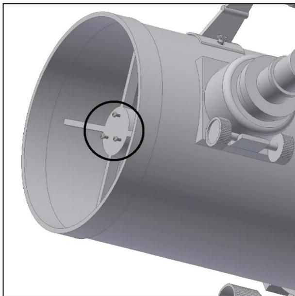
Figure 25. Vis de réglage du miroir secondaire
