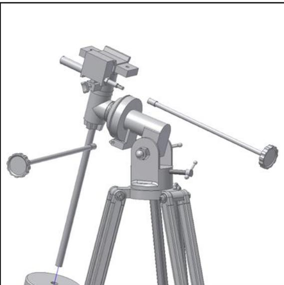
Figure 6. Fixer les poignées pour les axes AD et décl.
