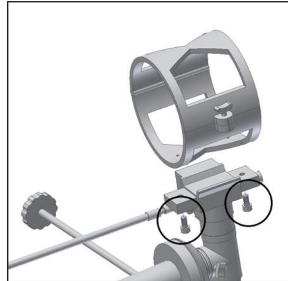
Figure 7. Fixer le collier de serrage du tube.
