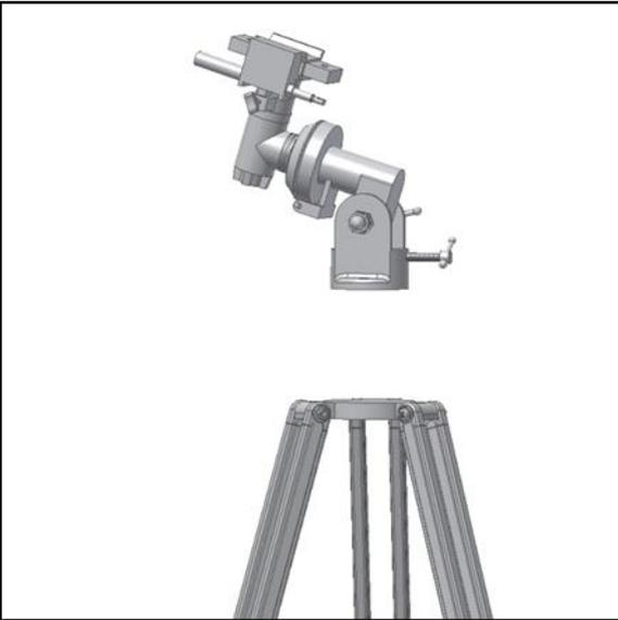
Figure 4. Placer la monture équatoriale sur le trépied.
