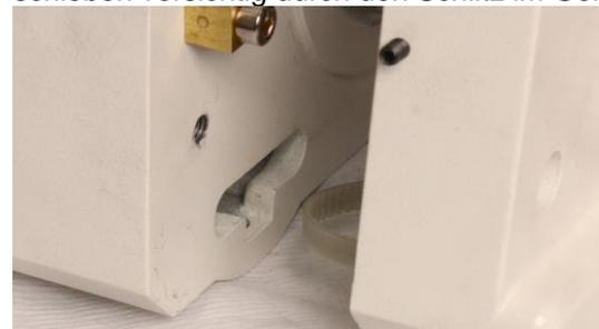
23. Setzen sie die vier Zylinderkopfschrauben wieder ein und legen sie diese nur an. Das finale einstellen des Schneckenspiels erfolgt zum Schluss.
