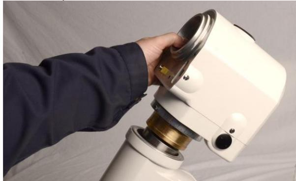
12. Lösen sie die Justier-Madenschrauben der RA-Schnecke..
