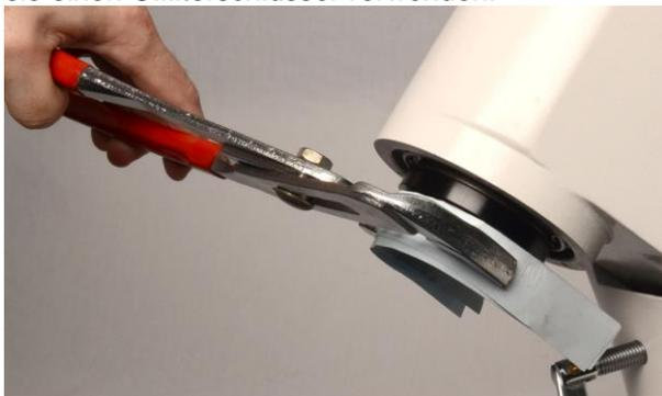
9. Entfernen sie den Ring und stellen sie sicher, dass das Kegelrollenlager der RA-Achse nicht auf den Boden fallen kann. Halten sie die Teile sauber und lagern diese am besten in einer Plastiktüte.
