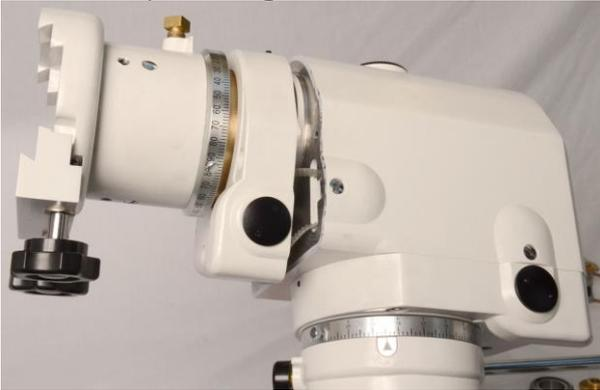
32. Montieren sie die Endkappe der DE-Achse mit der Gegengewichtsstange. Ziehen sie diese gerade so fest an, dass es kein Spiel mehr im Lager gibt. Ziehen sie die drei Madenschrauben an.
