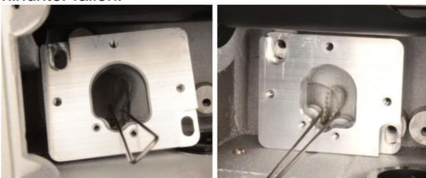
41. Setzen sie die Motorplatte so ein dass die Riemenscheibe durch die Öffnung hindurch innerhalb des Riemens liegt. Montieren sie die drei M4x12mm-Schrauben. Geben sie eine leichte Spannung auf den Riemen und drehen dabei die Schneckenwelle. Dadurch legt sich der Riemen passend auf die Riemenscheibe. Ziehen sie nun die M4 und M5 Schrauben an.
