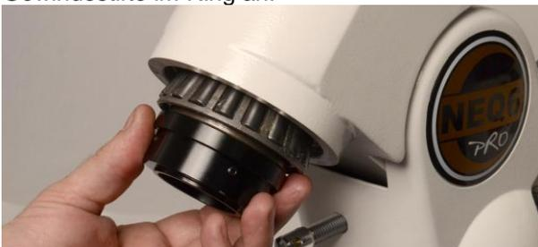
26. Nun arbeiten wir an der DE-Achse, entfernen sie den Klemmhebel lockern die Messingkupplung ein paar Umdrehungen.
