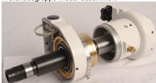
31. Führen sie während dem zusammensetzen der Baugruppen den Zahnriemen vorsichtig durch den Spalt im Gehäuse und legen die vier M6 Zylinderkopfschrauben wieder an. Das justieren des Schneckenspiels erfolgt zum Schluss.
