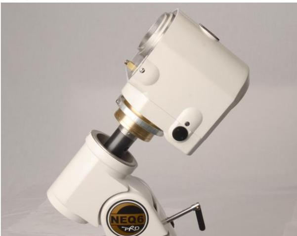
25. Setzen sie das Kegelrollenlager und den Haltering für den Polsucher zurück auf die Welle. Ziehen sie den Ring gerade so weit an, bis im Lager kein Spiel mehr herrscht. Ziehen sie die vier Gewindestifte im Ring an.
