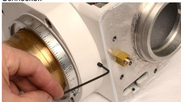
13. Entfernen sie die vier M6-Schrauben.
