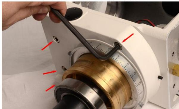
14. Entfernen sie das Schneckengetriebe von der RA-Achse. Notieren sie sich wieder die Position und Anzahl der Kunststoffpassscheiben.
