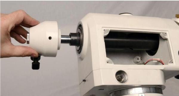
33. Die nächsten Schritte können an beiden Motoren parallel ausgeführt werden. Entfernen sie die drei M3 Zylinderschrauben.
