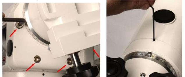
5. Ziehen sie die Wellenbaugruppe der DE-Achse vom Gehäuse ab. Achten sie auf den Ring des Kegelrollenlagers. Möglicherweise müssen sie mit einem Schonhammer die Achse herausklopfen. Notieren sie sich die Position und Anzahl der Kunststoffpassscheiben. Bewahren sie die Achse in einer Plastiktüte auf um sie sauber zu halten.
