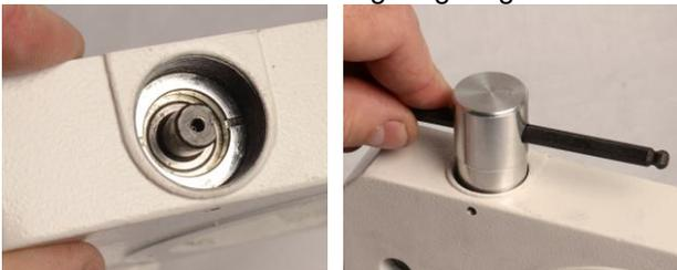
18. Ziehen sie die Schnecke seitlich aus dem Gehäuse um das Zahnrad frei zu bekommen. Möglicherweise müssen sie den gegenüberliegenden Lagerabschlussdeckel ebenfalls entfernen und vorsichtig auf die Welle klopfen.
