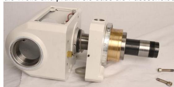
22. Führen sie den Riemen beim zusammenschieben vorsichtig durch den Schlitz im Gehäuse.
