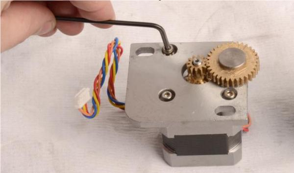
34. Lösen sie die beiden M4-Gewindestifte von der Welle und ziehen sie das Zahnrad ab. Feilen sie mit einer Nadelfeile den Grat der Schrauben von der Welle.
