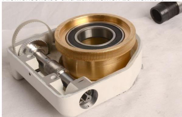
30. Setzen sie das Schneckengetriebe und die Wellenbaugruppe wieder zusammen.
