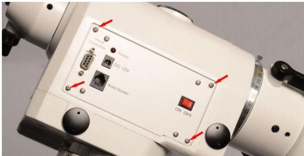
2. Entfernen sie beide Inbusschrauben von beiden Motoren. Ziehen sie beide Motoren aus dem Gehäuse. Markieren sie sich die Motoren den Achsen RA und DE entsprechend.
