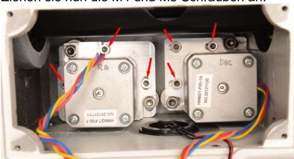
42. Schließen sie die Motoren und die LED wieder entsprechend an.
