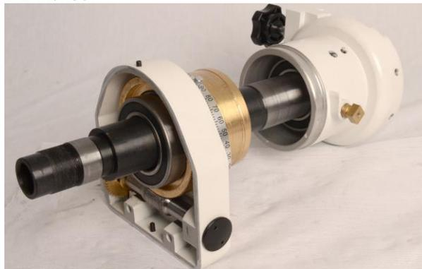
28. Lösen sie das Schneckenrad vom Gehäuse.
