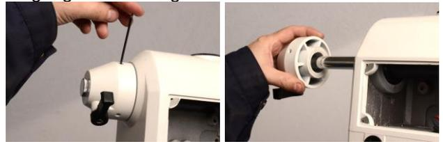
4. Entfernen sie die vier M6-Schrauben vom Gehäuse des Schneckengetriebes. Lösen sie beide Justier-Madenschrauben für die Schneckengetriebe vollständig.
