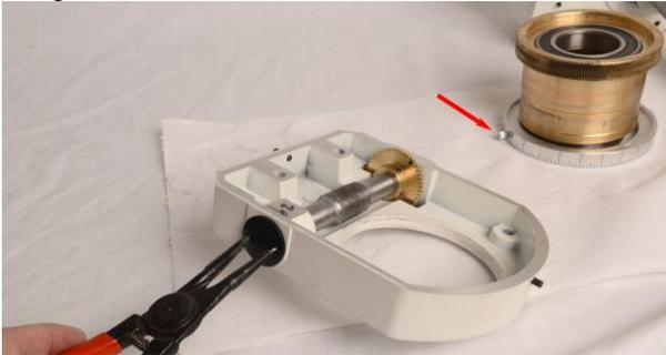
16. Lösen sie die beiden Schrauben des Zahnrades mit einem Inbusschlüssel.
