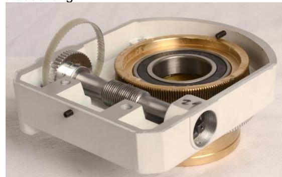
21. Setzen sie das Schneckengetriebe zurück auf die Welle und prüfen sie dass die Passscheiben.
