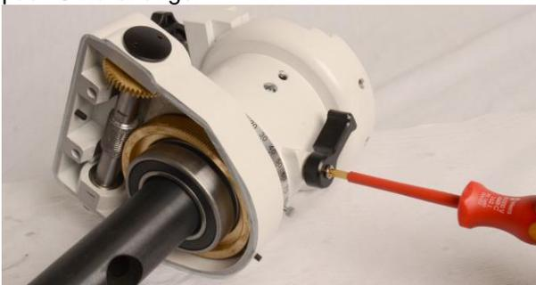
27. Entfernen sie das Schneckengetriebe von der DE-Achse.
