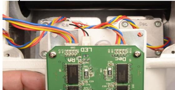
43. Setzen sie die Steuerung wieder so ein das sichergestellt ist das keine Kabel bewegliche Teile berühren können.
