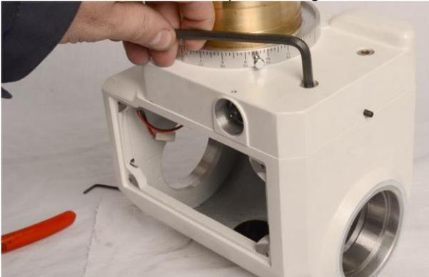
24. Setzen sie die Baugruppe der RA-Achse zurück ins Gehäuse.
