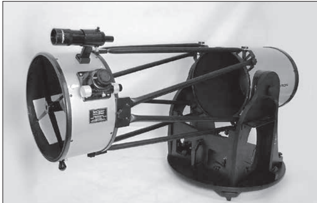
Figura 37. Configurazione del telescopio XX14i per la collimazione, con un pezzo di carta bianca di fronte al foccheggiatore e il tubo ottico in orizzontale. Se possibile, il telescopio dovrebbe puntare verso un muro di colore chiaro.
