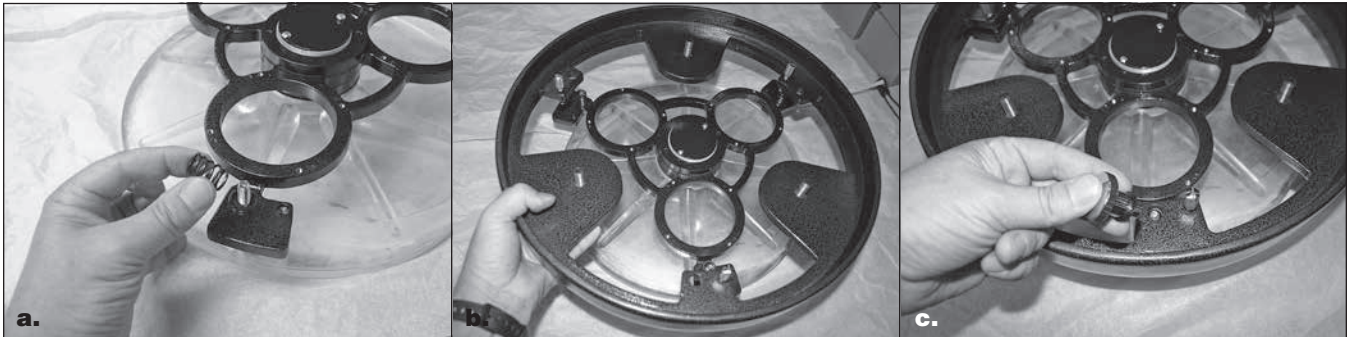
Figura 20. (a) Posizionare le tre molle sui perni filettati esposti dell'alloggiamento dello specchio. (b) Abbassare l'anello di chiusura posteriore sull'alloggiamento dello specchio in modo che i perni filettati dell'alloggiamento dello specchio attraversino l'anello, che deve appoggiare sulle molle. (c) Infilare le manopole di collimazione, con le rondelle in nylon inserite, sui perni filettati attraverso l'anello di chiusura posteriore. Assicurarsi di serrare le manopole di almeno tre giri completi sui perni.
