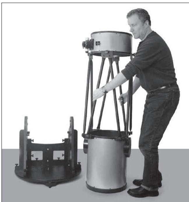
Figura 28. Sollevare il tubo ottico afferrando due pali del traliccio e abbassarlo con attenzione in modo che i mozzi grandi del cuscinetto per l'altitudine si appoggino sui cilindri del cuscinetto per l'altitudine sui pannelli laterali.
