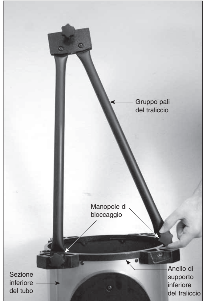
Figura 23. Le manopole di bloccaggio alle estremità dei pali del traliccio devono essere infilate nei fori sull'anello di supporto inferiore del traliccio sulla sezione inferiore del tubo.
