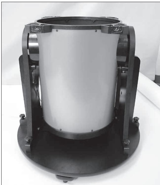
Figura 24. Invece di assemblare l'intero tubo ottico prima di sollevarlo per appoggiarlo sulla base, potrebbe essere più comodo montare prima la sezione inferiore del tubo sulla base e poi installare i tubi del traliccio e la sezione superiore del tubo.
