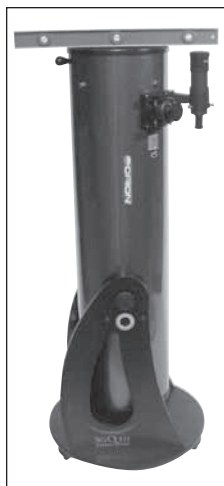
Figura 9. Una vez que la base esté nivelada, apunte el tubo hacia arriba, hasta que la celda del espejo entre en contacto con el tope vertical. Luego, coloque el nivel de carpintero en la parte superior del tubo, como se muestra. Si el tope vertical está configurado correctamente, la parte superior del tubo también debe estar nivelada.
