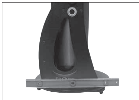
Figura 8. Coloque un nivel de carpintero en la base, tal como se muestra. La base debe mantenerse nivelada al rotar 180° en acimut. Una vez que se ajuste el tope vertical, no será necesario nivelar la base para su correcto funcionamiento.
