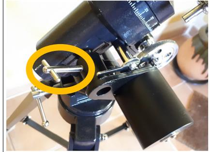
Montage terminé : vous pouvez visser sans forcer la vis entourée en jaune pour caler le moteur sur son arbre, le pignon du moteur est en appui sur la roue de réduction grâce à la tension du ressort. Le moteur peut maintenant être branché et utilisé normalement.
