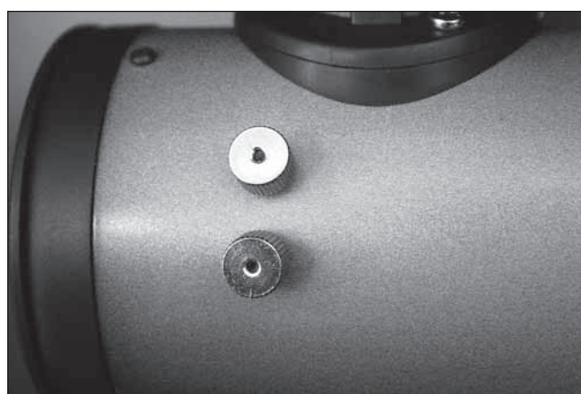
Figura 3: viti zigrinate di fissaggio del mirino EZ Finder II
