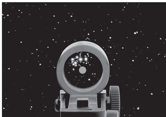
Figura 19. Il mirino EZ Finder II proietta un minuscolo puntino rosso nel cielo, mostrando esattamente dove è puntato il telescopio.
