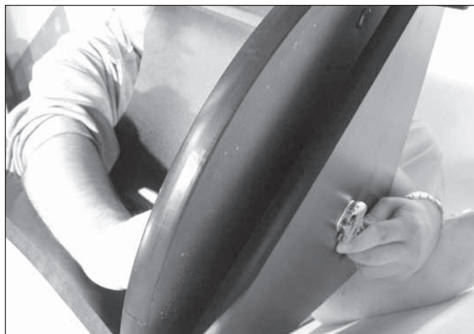
Figura 9. Quando si rimontano le piastre base, inclinarle leggermente, come mostrato, senza appoggiarle su un lato. Usare una chiave per tenere ferma la testa del bullone dell'asse azimutale, mentre si gira il controdado esagonale con l'altra chiave.
