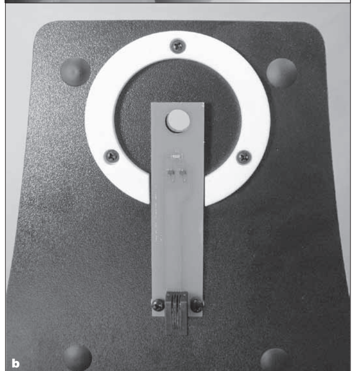
Figura 12. (a) Scheda dell'encoder per l'altitudine da installare con una rondella su ogni vite. (b) Scheda dell'encoder per l'altitudine installata.
