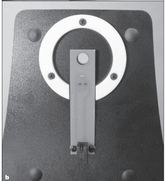
Figure 12. (a) Installation de la carte de l'alticodeur. Placez une rondelle sur chaque vis, comme illustré. (b) La carte de l'alticodeur est installée.
