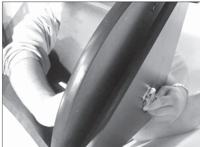
Figure 9. Pour assembler les plaques inférieure et supérieure, inclinez-les légèrement, comme indiqué. Ne les placez pas de côté. Utilisez une clé pour maintenir la tête du boulon de l'axe azimut pendant que vous vissez le contre-écrou hexagonal avec l'autre clé.
