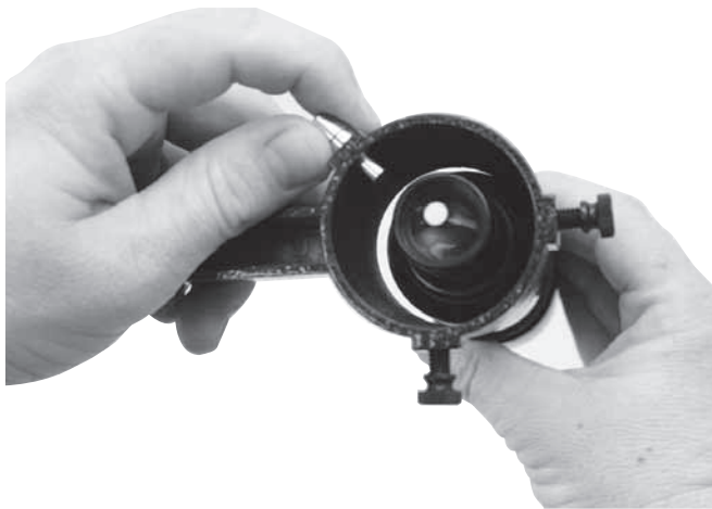
Figure 3b. Tirez le dispositif de tension vers l'arrière et glissez le chercheur dans son support jusqu'à ce que le joint torique se loge dans l'anneau du support.
