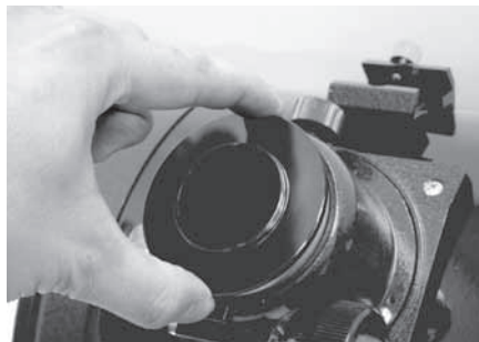
Figure 22b. Vissez l'adaptateur de l'appareil photo dans le tube du porte-oculaire
