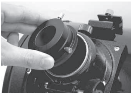
Figure 22a. Commencez par retirer les deux adaptateurs de 1,25" (31,75 mm) et 2" (50,8 mm) comme illustré
