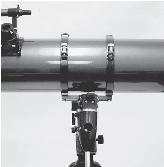
Figure 11. Le tube optique doit faire un angle de 90^\circ avec l'axe d'ascension droite afin de voir à travers le viseur de l'axe polaire
