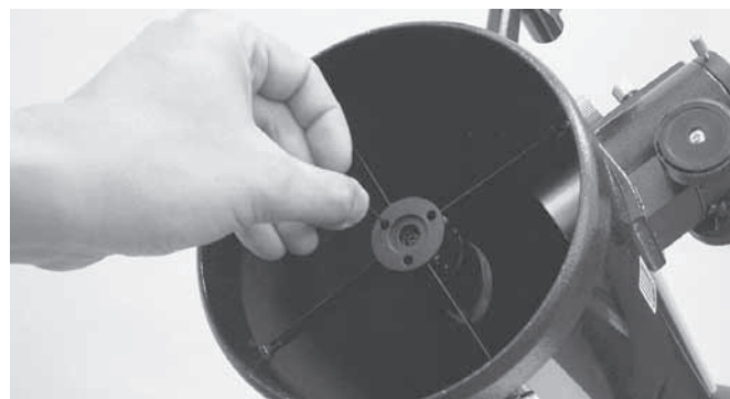
Figure 16. Ajustez l'inclinaison du miroir secondaire en desserrant ou en serrant les trois vis d'alignement à l'aide d'une clé hexagonale de 2 mm.
