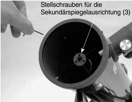
Abbildung 17. Stellen Sie die Neigung des Sekundärspiegels durch Lockern oder Festziehen der drei Stellschrauben für die Sekundärspiegelausrichtung mit einem Innensechskantschlüssel (2 mm) ein.
