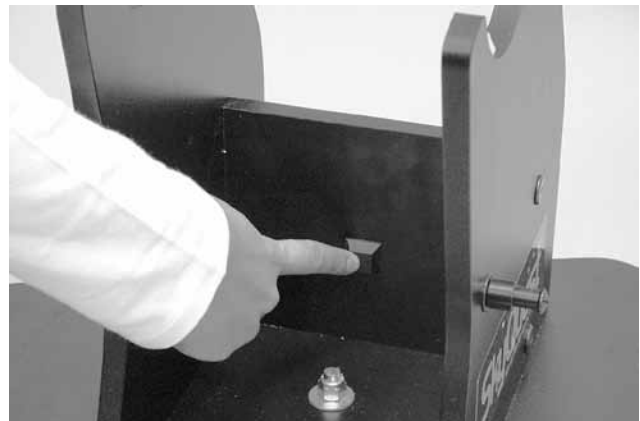
Abbildung 3. Befestigen Sie das Gummipolster auf der Markierung an der Innenseite der Frontplatte.
