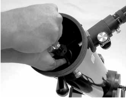
Abbildung 16. Zum Zentrieren des Sekundärspiegels unter dem Fokussierer halten Sie den Spiegelhalter mit den Fingern fest, während Sie die mittlere Schraube mit einem Kreuzschlitz-Schraubendreher festziehen. Berühren Sie keinesfalls die Spiegeloberfläche.
