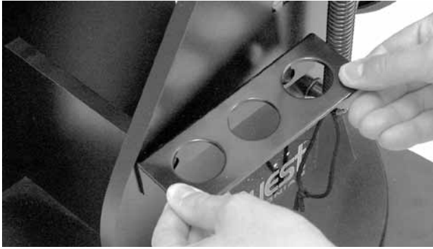
Abbildung 4. Befestigen Sie das Okulargestell aus Aluminium mit den beiden mitgelieferten Schrauben in den Bohrungen, die sich etwa in der Mitte der linken Seitenwand der Basis befinden.
