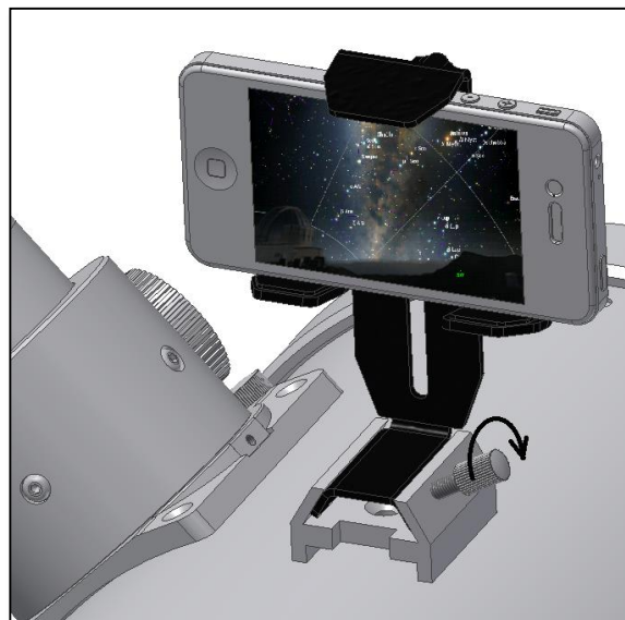
Figura 5.Deslice la base sobre la zapata tipo Vixen del buscador. Recuerde fijar el tornillo de la misma.
