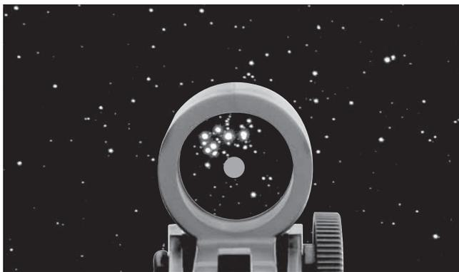
**Abbildung 5:** Der EZ-Finder-II projiziert einen roten Punkt auf den Himmel und zeigt genau an, worauf das Teleskop ausgerichtet ist.
