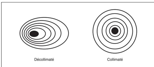
**Figure 18.** Un test d'étoile permet de déterminer si l'optique du télescope est correctement collimatée. Une image non mise au point d'une étoile lumineuse à travers l'oculaire doit apparaître comme illustré à droite si l'optique est parfaitement collimatée. Si le cercle est asymétrique, comme illustré à gauche, le télescope doit être collimaté.
