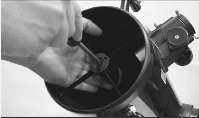
**Figure 14.** Pour centrer le miroir secondaire sous le système de mise au point, maintenez le support du miroir en place d'une main tout en ajustant le boulon central à l'aide d'un tournevis cruciforme. Ne touchez pas la surface du miroir !
