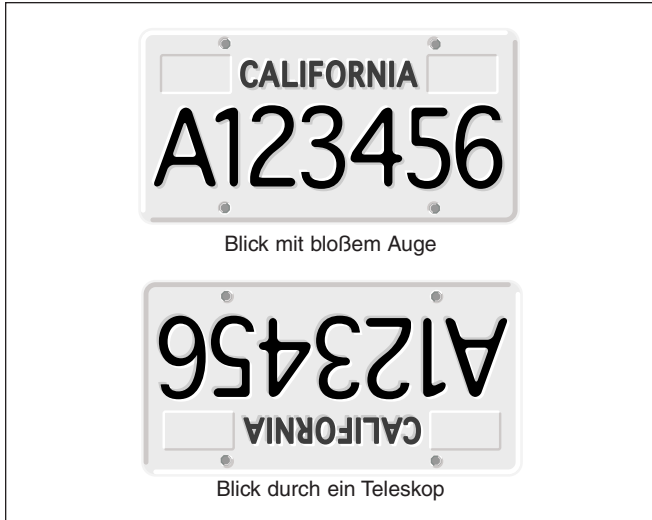
Abbildung 11. Beim Blick durch ein Spiegelteleskop steht das sichtbare Bild auf dem Kopf.
