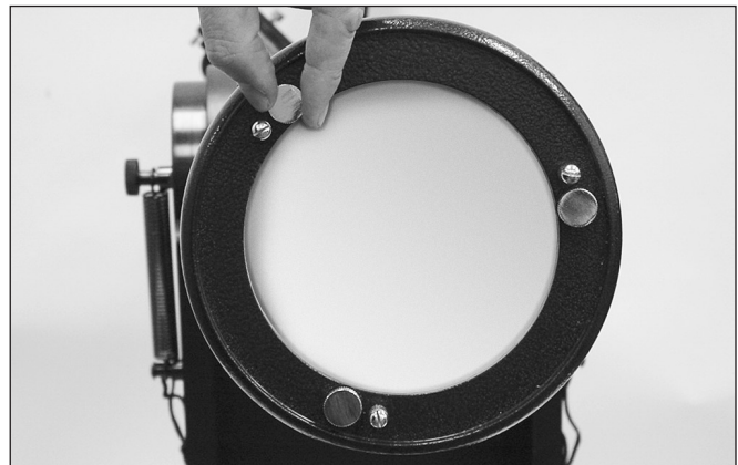
Abbildung 17. Die Neigung des Primärspiegels wird durch Drehen einer oder mehrerer der drei größeren Rändelschrauben eingestellt.
